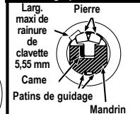
Vue en coupe de l'Unité de Rodage pour Clavette
